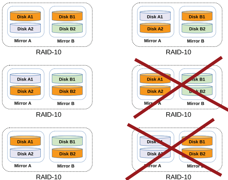
Рис. 3.2. В случае выхода из строя по одному HDD из различных «зеркал» (mirror) работоспособность RAID-10 сохраняется
